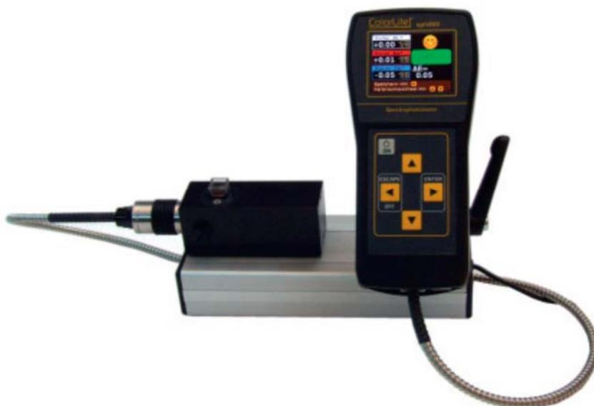
Dispone de dos configuraciones para la determinación del color en líquidos opacos o transparentes. Permite medir por transmisión o por reflexión. Adicionalmente a las funciones y capacidades del instrumento es capaz de conectarse a un software PC para el cálculo de los diferentes parámetros y coordenadas del color.
